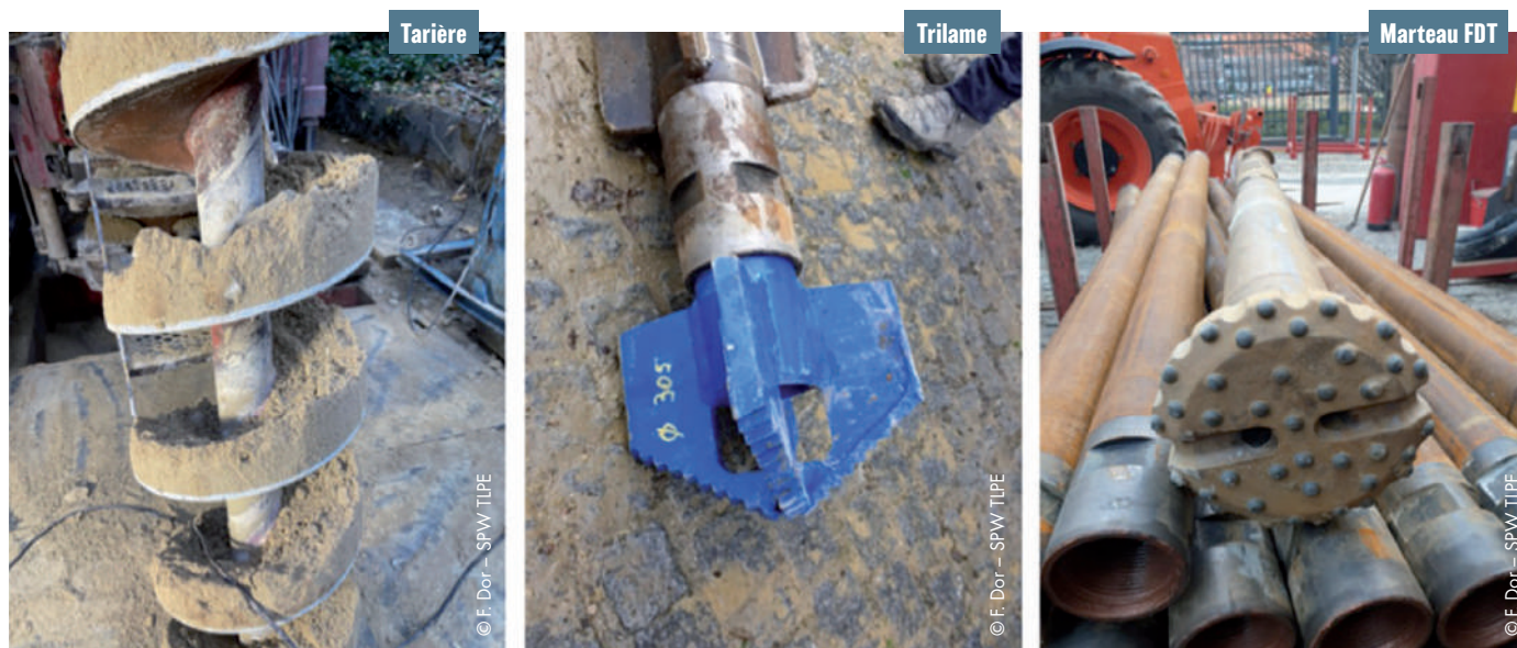
Figure 5 : Photos présentant les outils de forage courants en Belgique pour l'installation d'échangeurs géothermiques. La tarière est adaptée aux terrains meubles alluvionnaires ou sableux ou crayeux meubles ne présentant pas de difficultés particulières, le trilame en cas de formations dites meubles (sable, limon, argile) et le marteau fond de trou (FDT) est préconisé en présence de terrains durs et homogènes.
